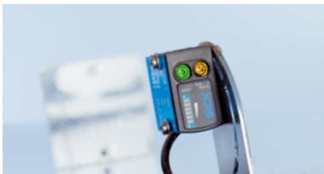
BluePilot w przypadku RAY10: im mniejsza odległość między niebieskimi diodami LED, tym większe zabrudzenie
