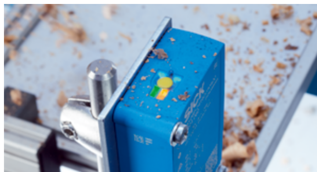
BluePilot w przypadku RAY26: im mniejsza odległość między niebieskimi diodami LED, tym większe zabrudzenie
