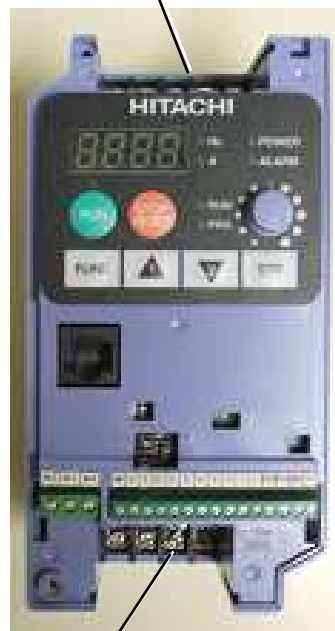
Zaciski do przyłączenia silnika oraz zaciski do podłączenia urządzeń opcyjnych (dławik DC, jednostka hamująca)
